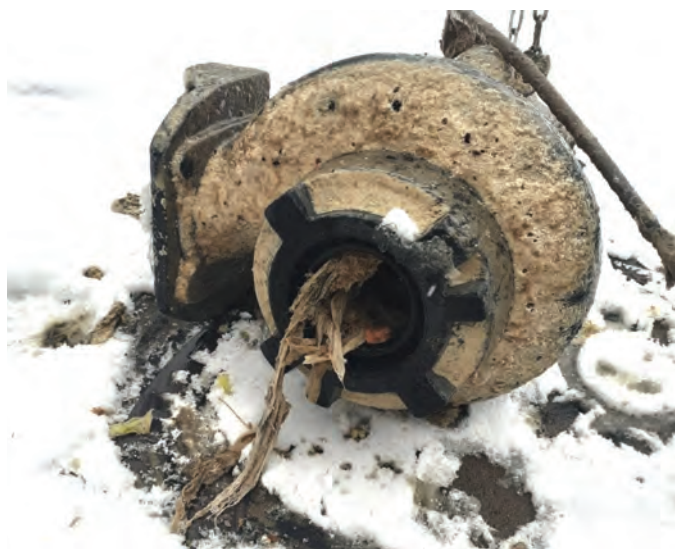
Čerpadla ucpaná zakázaným odpadem ve splaškové kanalizaci
